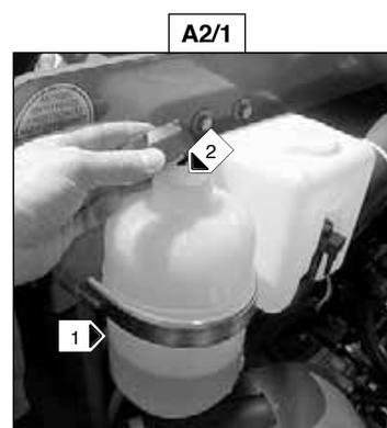
Lorsque le vase d'expansion est vide, contrôler le niveau dans le radiateur avant de remplir le vase d'expansion.
