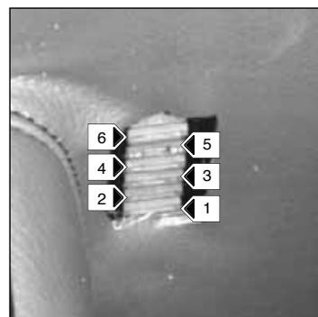
NOTA : Remplacer un fusible usagé par un fusible neuf de même qualité et capacité. Ne jamais réutiliser un fusible réparé.
